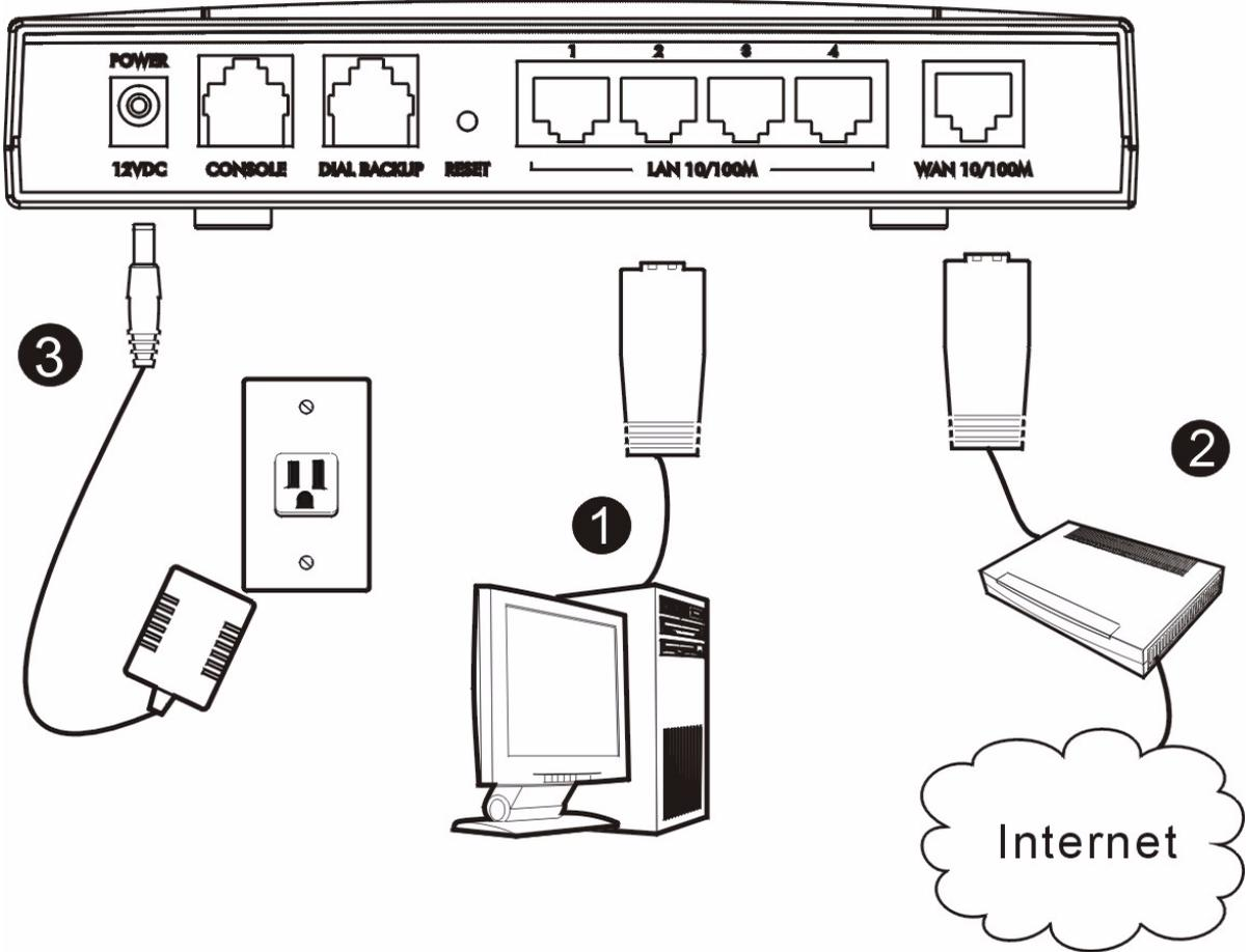
1 Använd en Ethernet-sladd för att ansluta **LAN**-porten till en dator.
