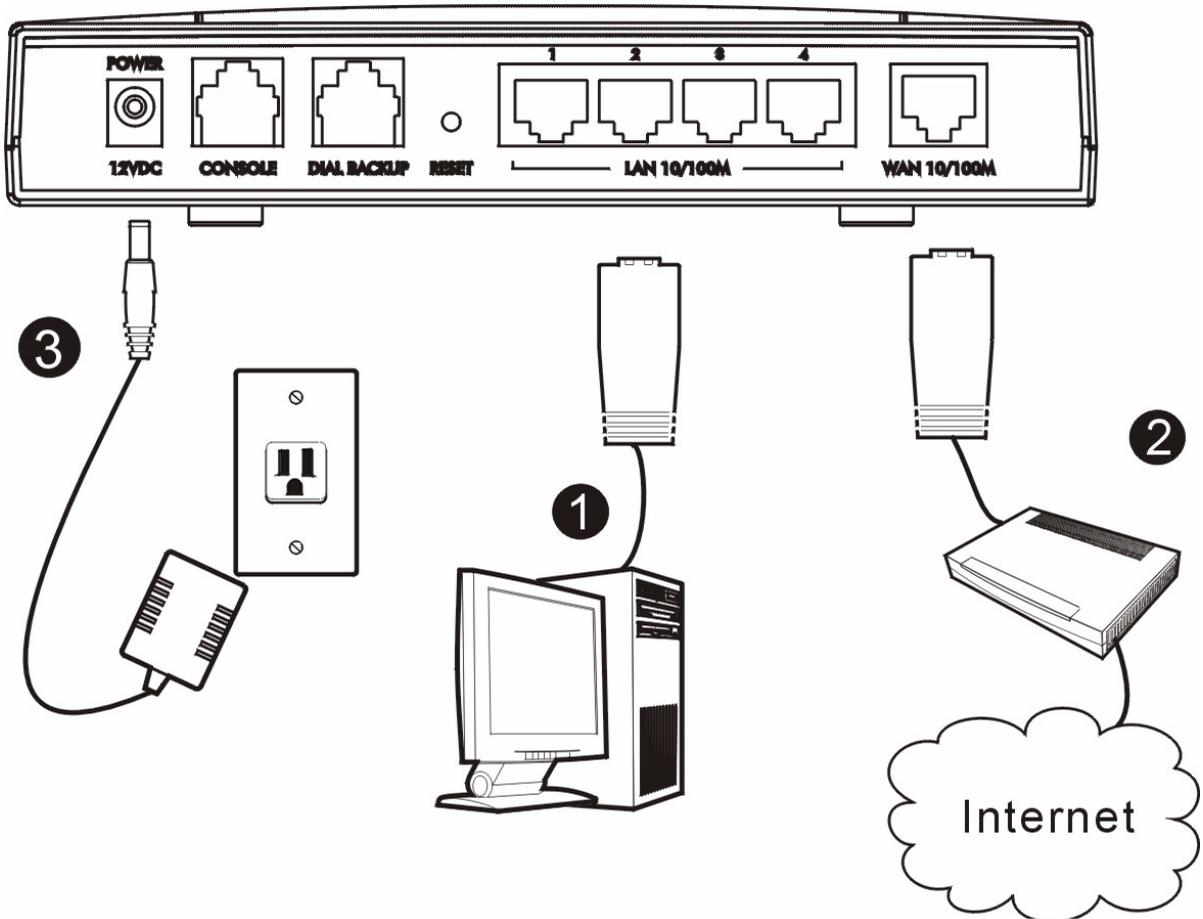
1 Для подключения порта **LAN** к компьютеру используется кабель Ethernet.
