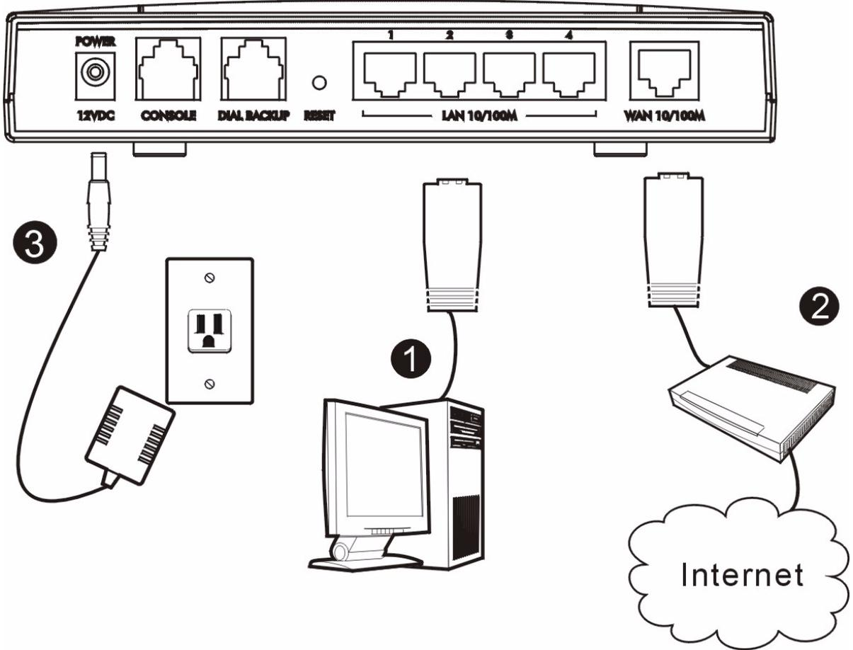
1 Verbinden Sie den **LAN**-Anschluss mit einem Ethernet-Kabel mit einem Computer.
