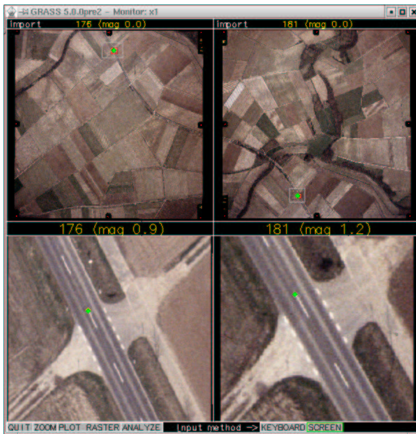
Abbildung 9.3.: Nutzung von i.points zur Identifizierung von Passpunkten in Orthophotos
