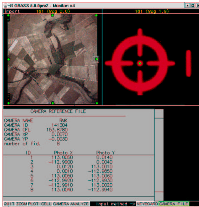
Abbildung 9.1.: Identifizierung der Rahmenmarken in GRASS
